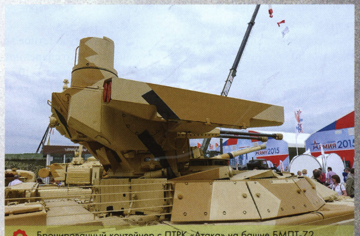
Бронированный контейнер с ПТРК «Атака» на башне БМПТ-72 «Терминатор-2». Сверху хорошо виден панорамный прицел командира машины.
