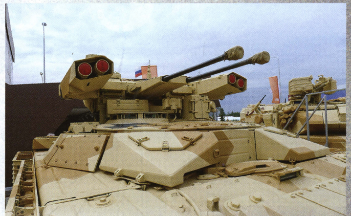
Башня с вооружением БМПТ-72 «Терминатор-2». Хорошо видны блоки дополнительной защиты.
