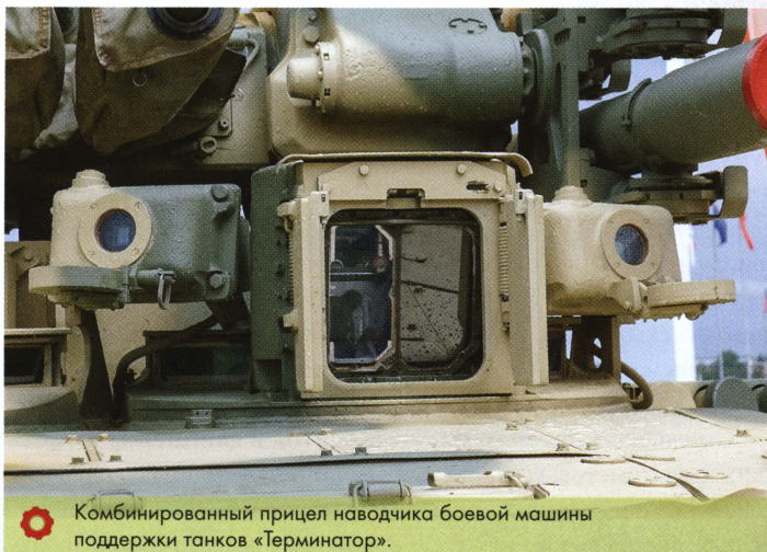
Прицел «Агат-МП» наводчика-оператора курсового гранатомета АГ-17Д боевой машины поддержки танков «Терминатор».
